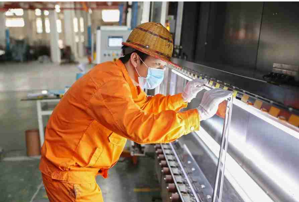
Cẩn thận phù hợp với butyl & nhôm với kính
