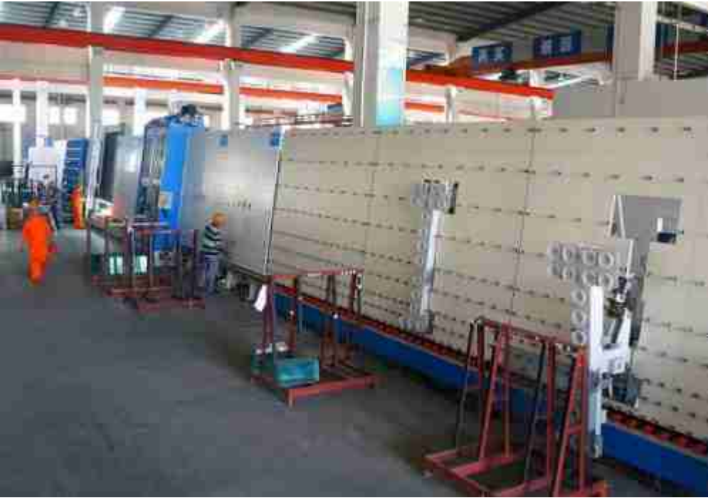
Bystronic dây chuyền niêm phong hoàn toàn tự động cho ba lớp kính
