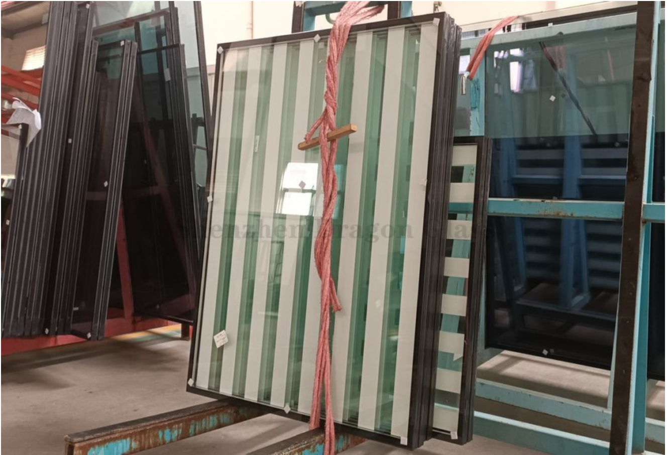
Tấm kính cách nhiệt 8mm + 12A + 8mm cho cửa sổ
