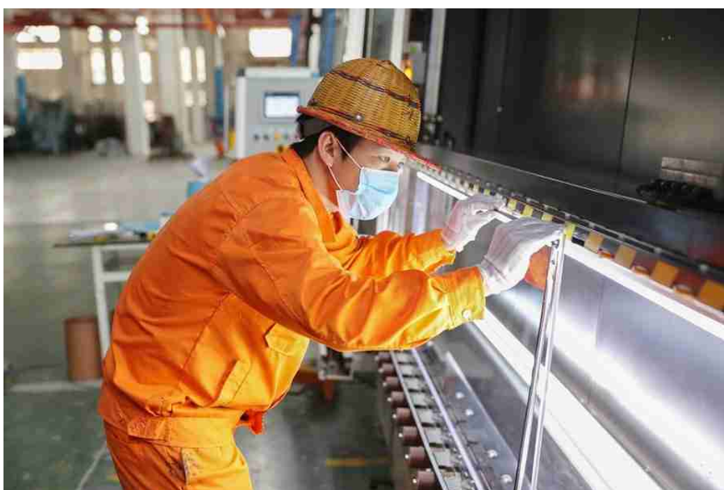
Тщательное сопоставление бутил и алюминиевого спейсера со стеклом
