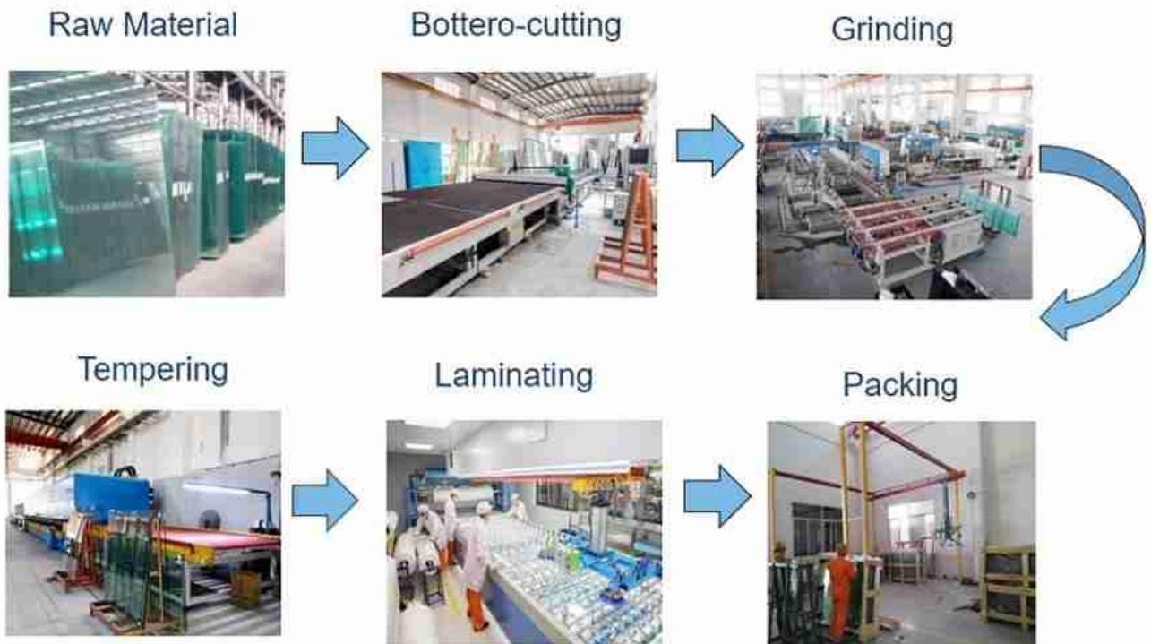
производственные детали 8'1.52pvb'8mm ясно закаленной ламинированной стеклянные поручни для балкона
