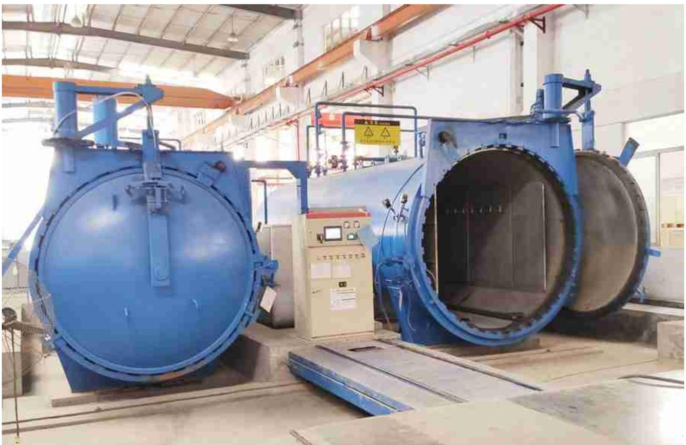
*Ламинированные стеклянные производственные машины - автоклав высокого давления*
