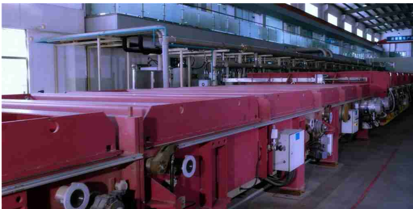
Линия напыления большой площади для производства светоотражающего стекла.
