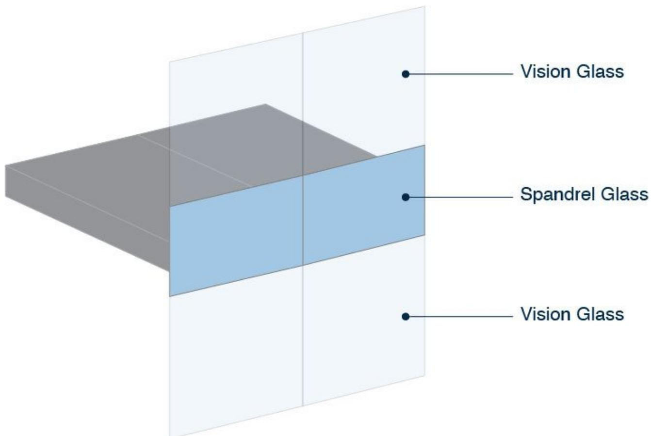
Стекло Vision прозрачно, как и обычные стеклянные окна, такие как стекло Low-E, [солнцезащитное стекло](#), изоляционное стекло и т. д. Тем не менее, стекло перемычки спроектировано так, чтобы быть непрозрачным, чтобы скрыть некоторые части строительных конструкций.
