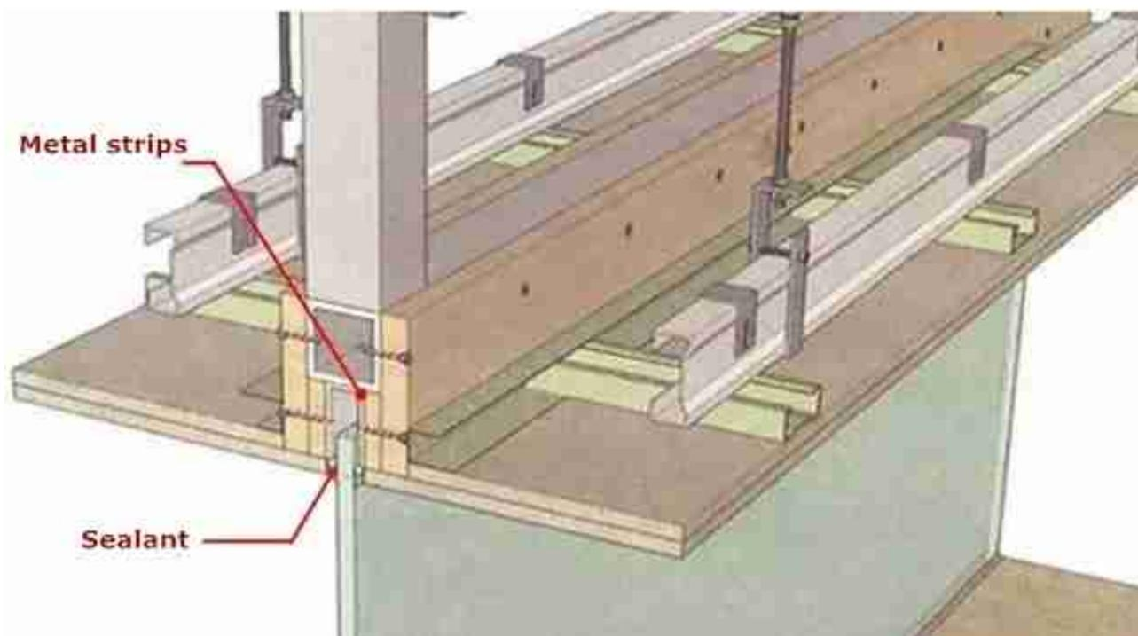
3. Установка стальных компонентов в нижней части канала в соответствии с требованиями размера чертежей. После установки используйте болты расширения для фиксации и установки стального стеклянного бака в верхней части и с обеих сторон. Затем проверьте установленный стеклянный бак, чтобы убедиться, что он прямой и исправить его.
