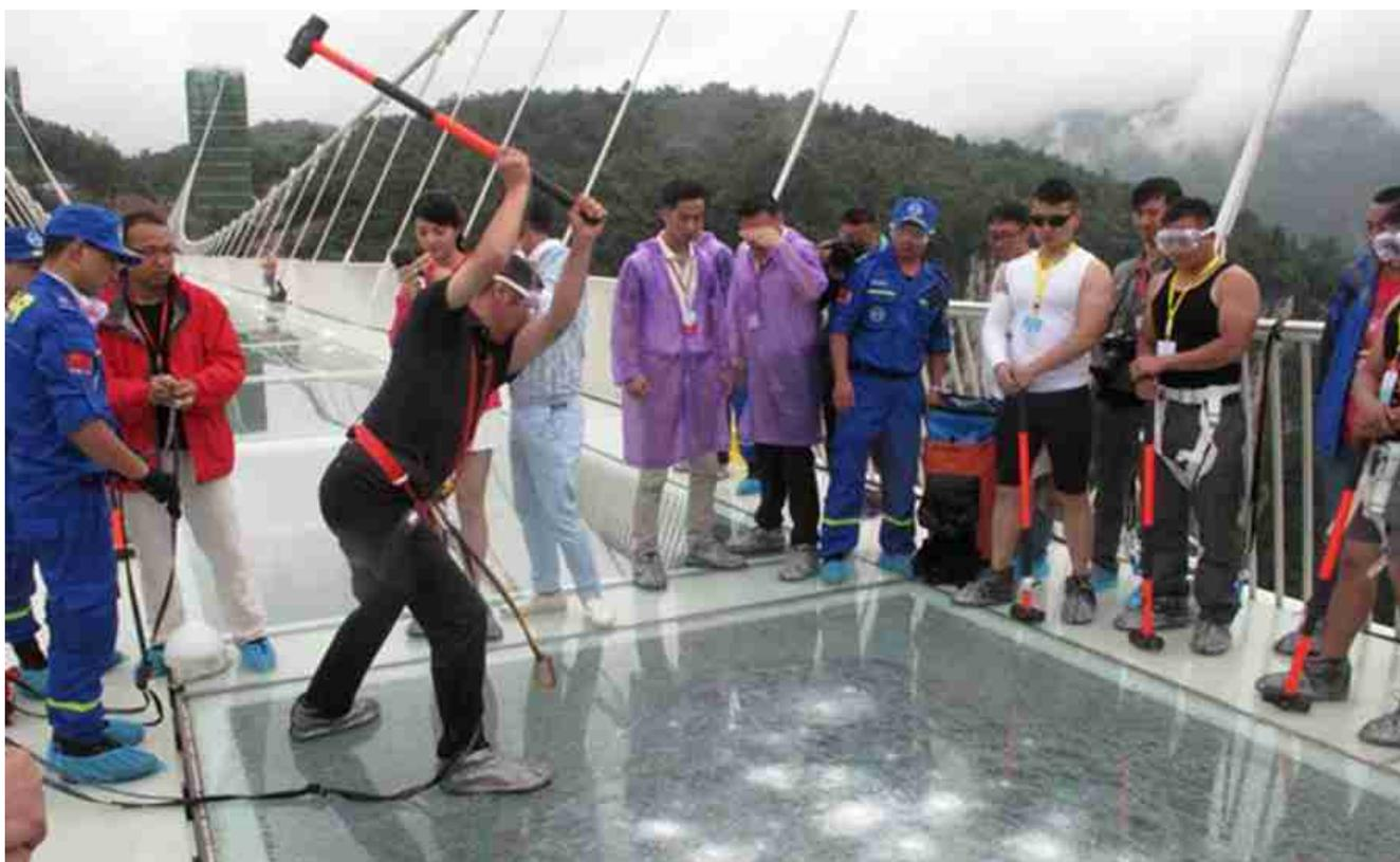
*SGP ламинированный стеклянный настил прочного сильного тестирования воздействия*
