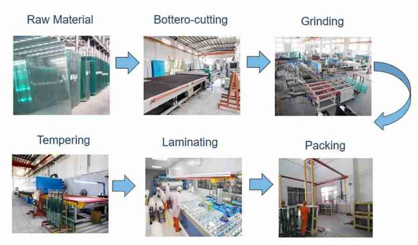
*процесс производства ламинированного акустического стекла*
