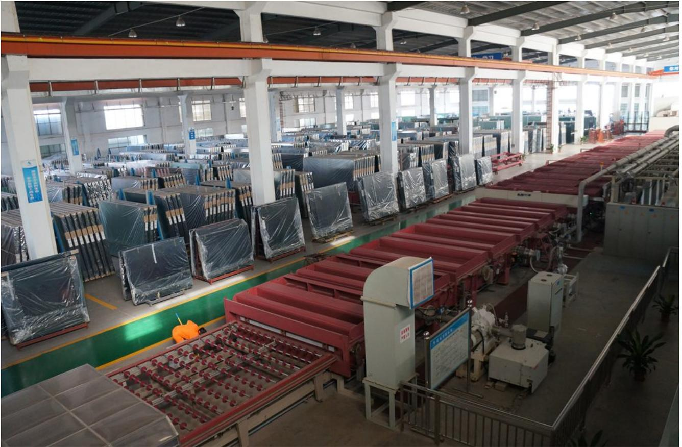
***Линия по нанесению отражающего покрытия на стекло***
