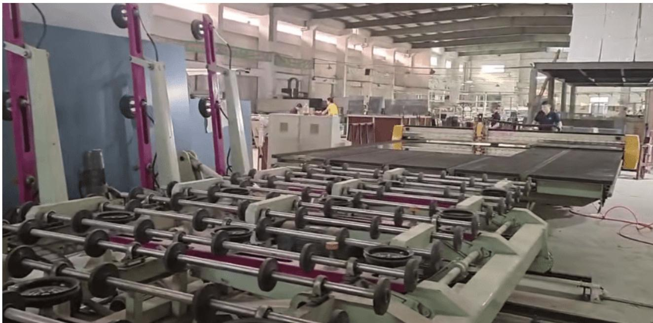
Автоматическая режущей линии, как показано включает в себя оборудование мэйнфрейм / оборудование ходьбе системы / системы передачи оборудования / вакуумной системы всасывания / механические опрокидывания системы.
