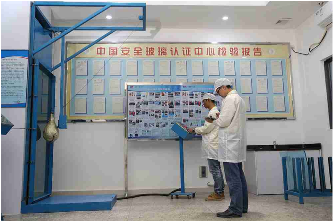
Teste de impacto para vidro laminado.
