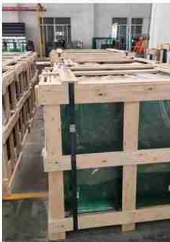
Detalhes de embalagem de grades de vidro exterior
