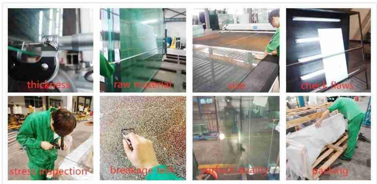
*Inspeção de processo de vidro endurecido.*
