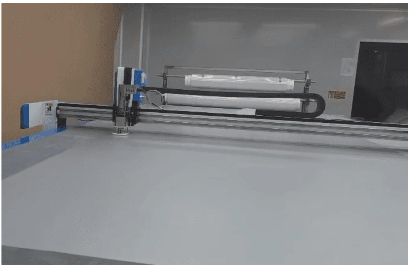
A máquina de corte mais avançada está trabalhando para cortar o tamanho real do filme PDLC. O filme Polímero Dispersed Liquid Crystal (PDLC) é um tipo de vidro inteligente ou filme que altera sua transparência em resposta a um impulso elétrico. As telas PDLC têm sido usadas em ambientes internos e externos para controle de privacidade (por exemplo, salas de conferência, áreas de terapia intensiva, portas de banheiro/chuveiro, salas de montagem) ou como uma tela de projeção temporária.
