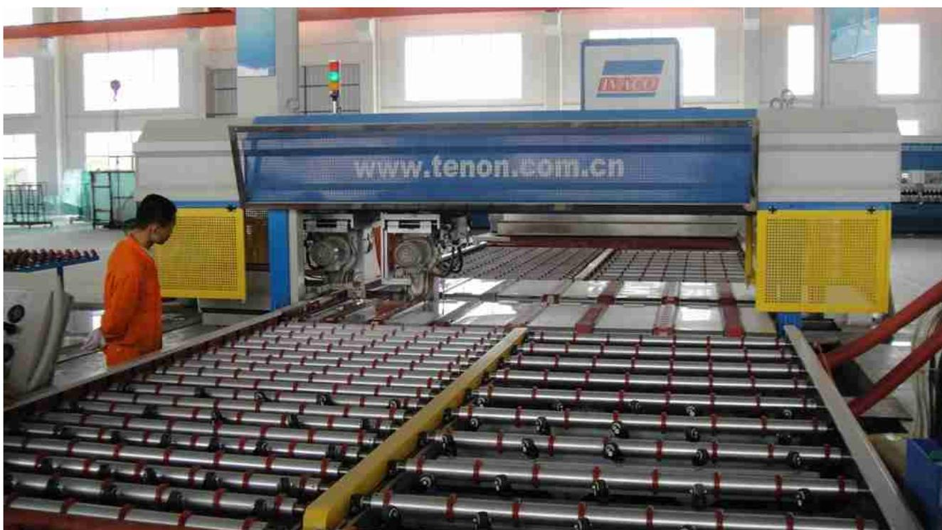
2, Faça um bom polimento de borda para o vidro transparente de 12mm, certifique-se de que não há chips, sem arranhões durante o processo;
