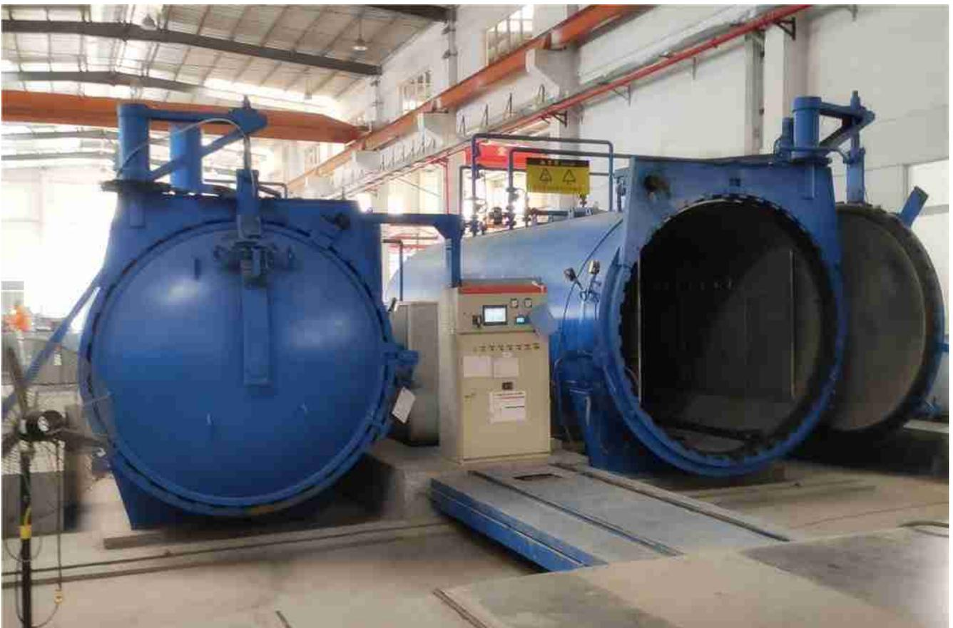
*Autoclave de laminação de vidro de alta pressão*
