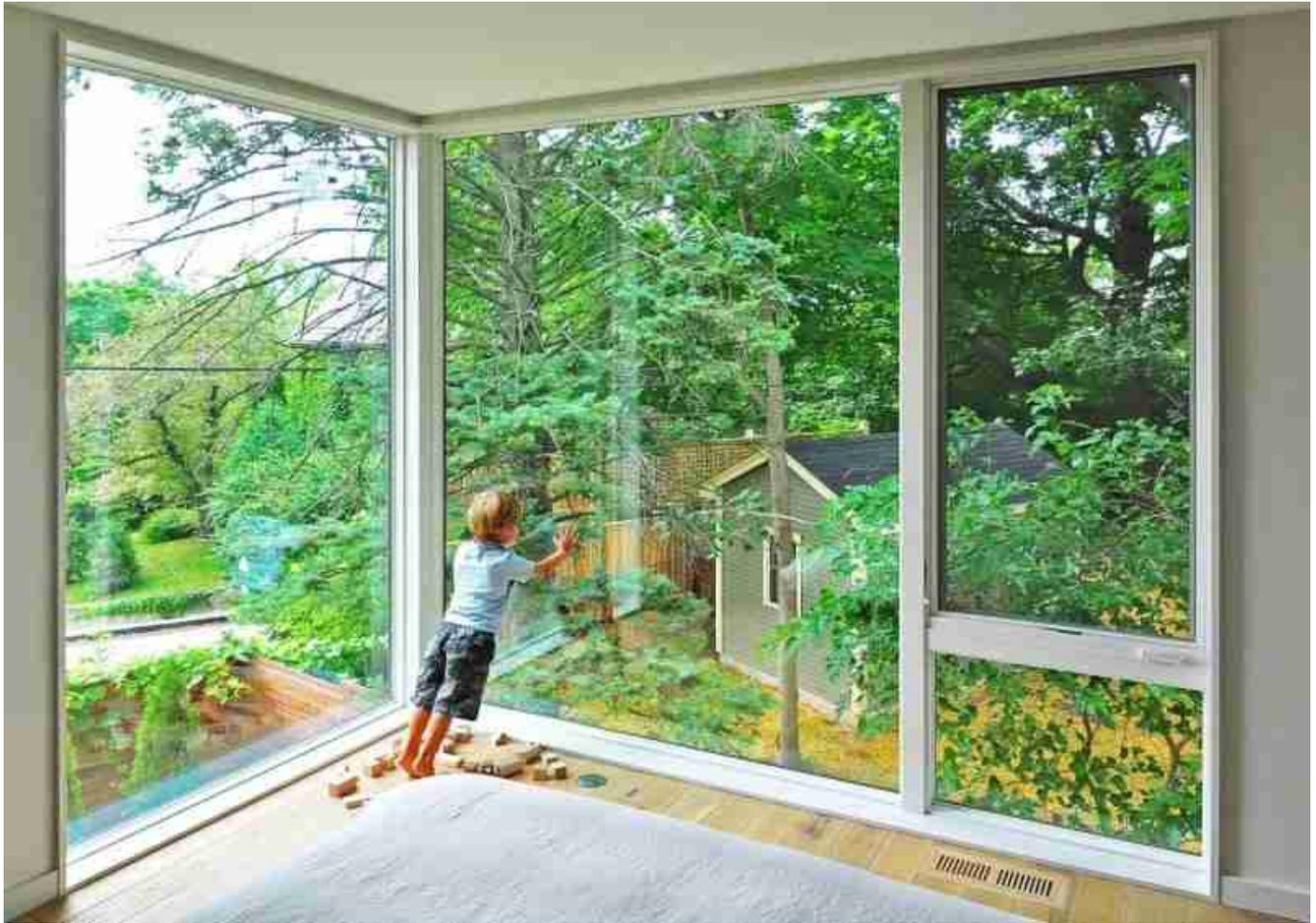
*17,52mm de espessura de vidro temperado laminado para suportar forte impacto e fornecer visão clara*
