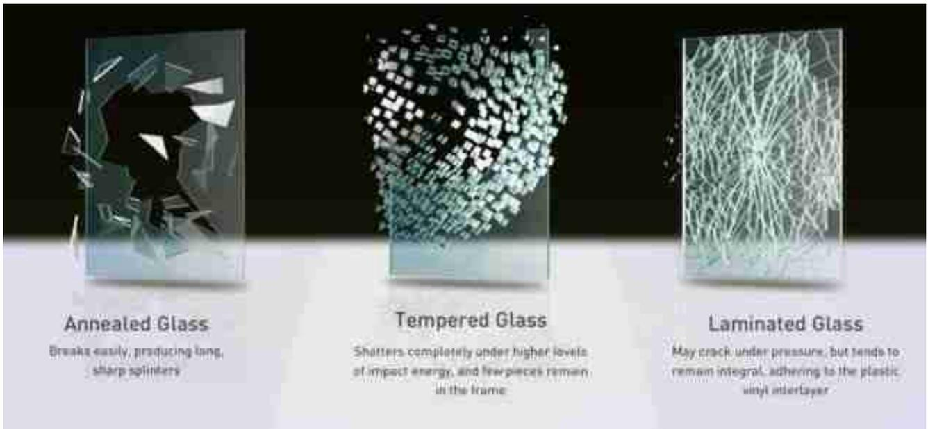
*Vidro recozido VS vidro temperado VS vidro laminado*
