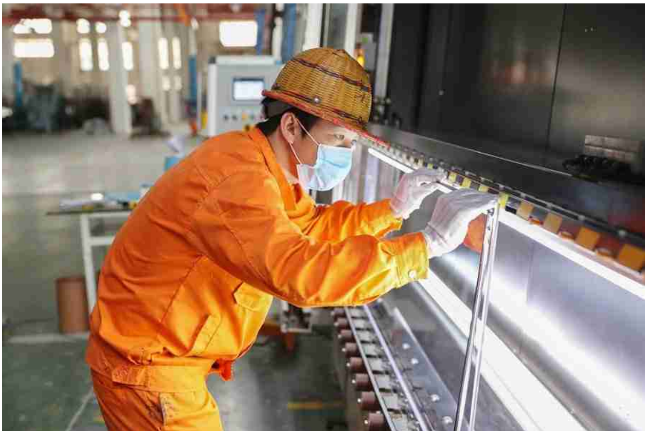
Combinando cuidadosamente o tamanho do espaçador e o vidro com o selante butyl.
