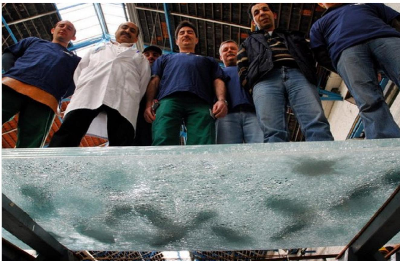
*a resistência residual do vidro laminado SGP multicamada após a quebra*
