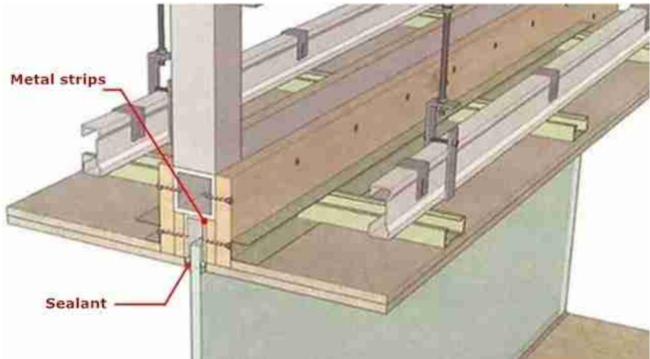
3. Instale os componentes de aço na parte inferior do canal de acordo com os requisitos de tamanho dos desenhos. Após a instalação, use parafusos de expansão para fixar e instalar o tanque de vidro de aço na parte superior e em ambos os lados. Em seguida, verifique o tanque de vidro instalado para garantir que ele está reto e fixá-lo.
