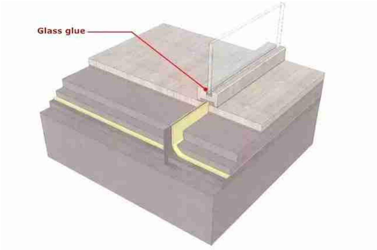
5. Instale a partição de vidro, antes de instalar, limpe a ranhura de vidro para garantir a limpeza da superfície, para que possa instalá-la dentro! Depois, ajuste a partição da parede de vidro para garantir que ela esteja fixa.
