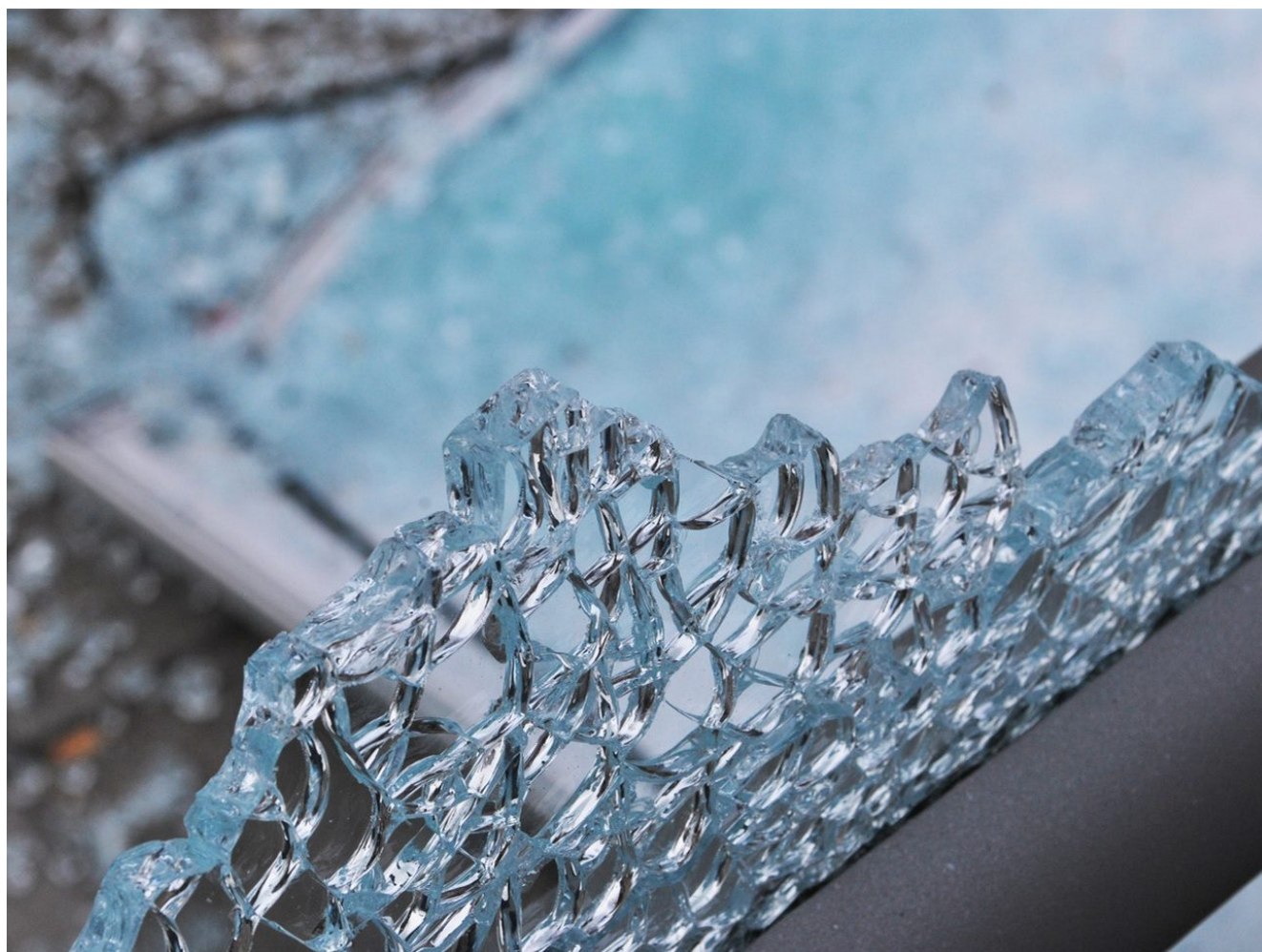
vidro temperado quebrado
