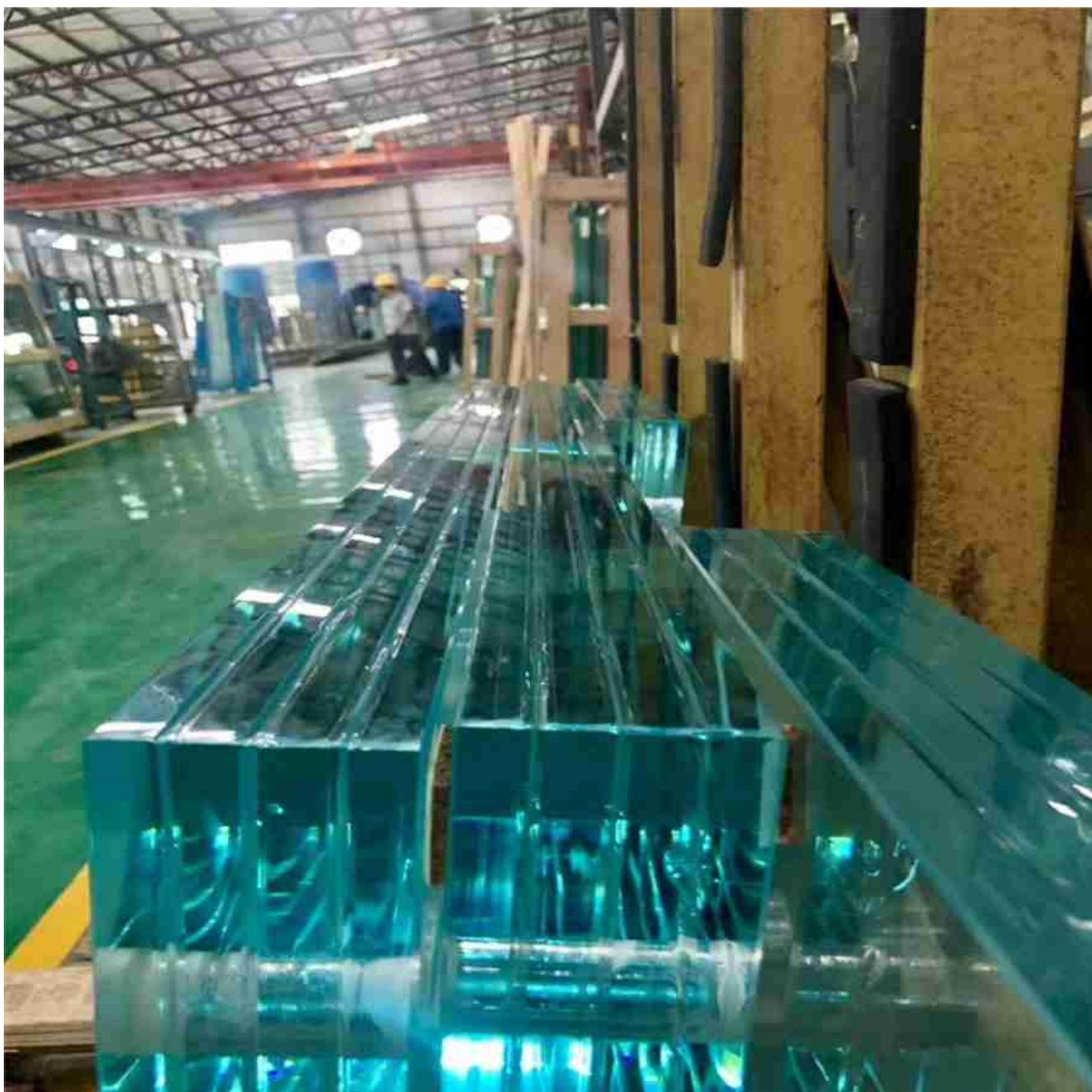
O vidro temperado laminado está usando duas ou mais peças de sanduíche de painéis de vidro temperados com material intercamado como material PVB ou SGP ou EVA, suportando alta pressão e alta temperatura, tornando a junta de vidro permanentemente unida. Quando um ou mais painéis no vidro laminado são quebrados devido ao impacto extremo, as peças quebradas ainda colam junto com as intercamadas PVB ou SGP. Evitar que peças de vidro se espalhem e garantir a segurança.
