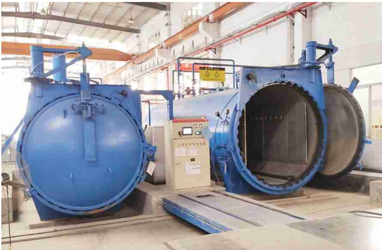
*Autoclave de fabricação de vidro laminado de alta pressão*
