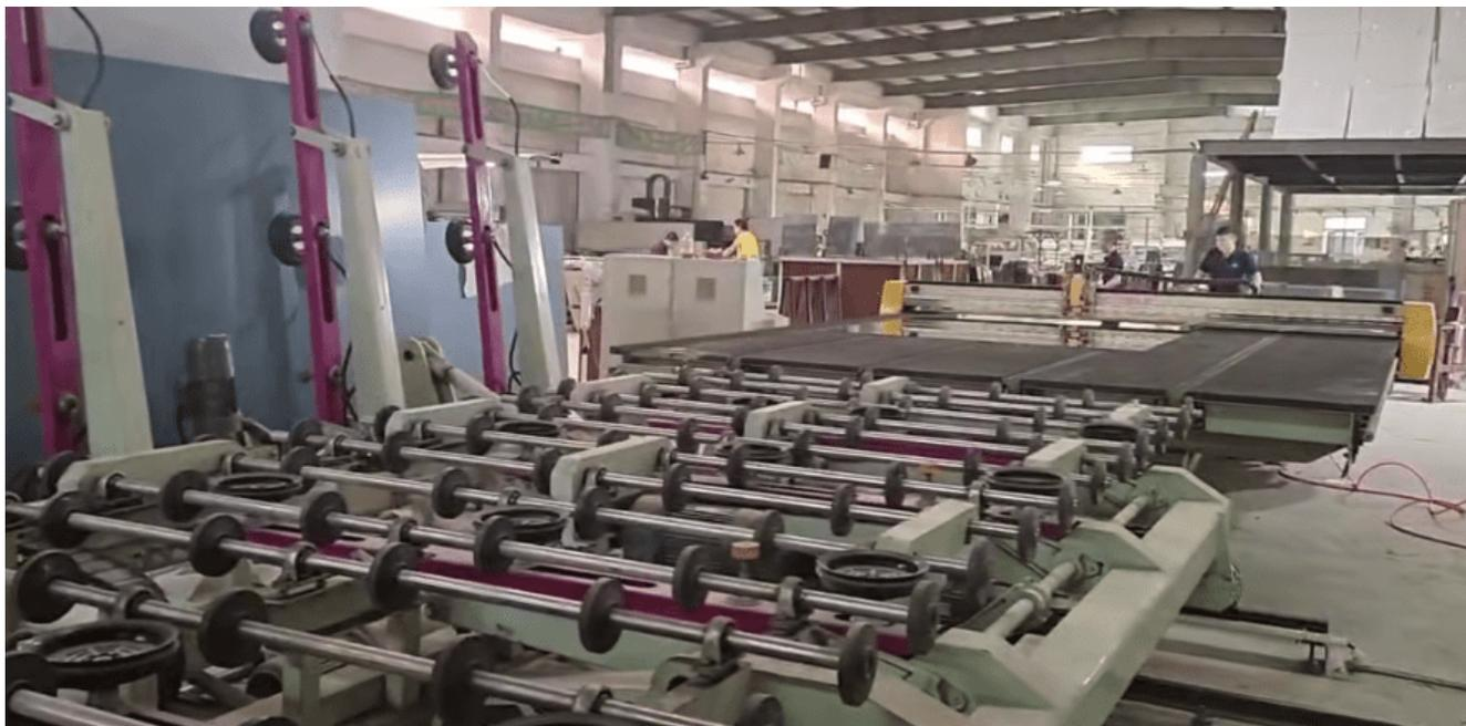
A linha de corte automática, como mostrado inclui o sistema de caminhada do sistema de caminhada do equipamento/sistema de transmissão de equipamentos/sistema de sucção a vácuo / capotamento mecânico do sistema.
