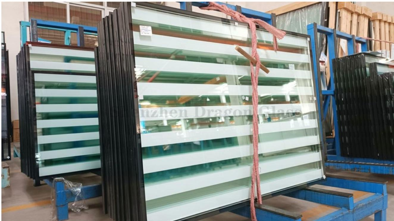
*Painéis de vidro isolados 8mm+12A+8mm para janelas*
