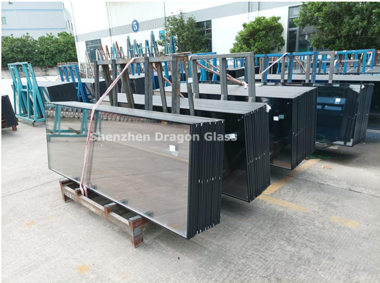
***6mm low-E temperado + 9 A + 6mm vidros isolados temperados transparentes***
