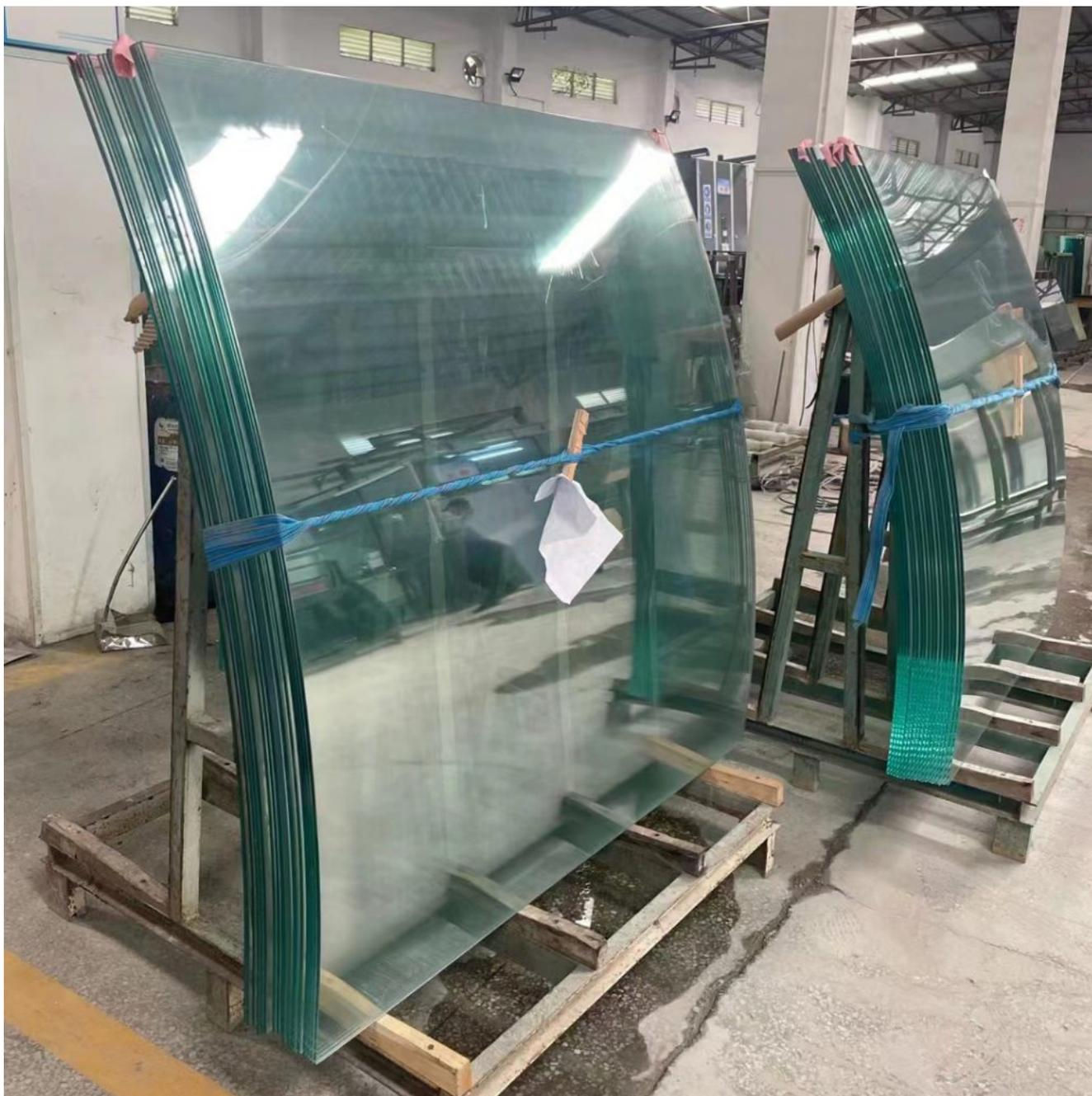
O vidro laminado curvo oferece aos arquitetos e designers mais opções de design. É moderno e atraente. O vidro curvo se destaca das superfícies de vidro planas normais. E como um tipo de vidro de segurança, é amplamente utilizado para grades de vidro, vidro
