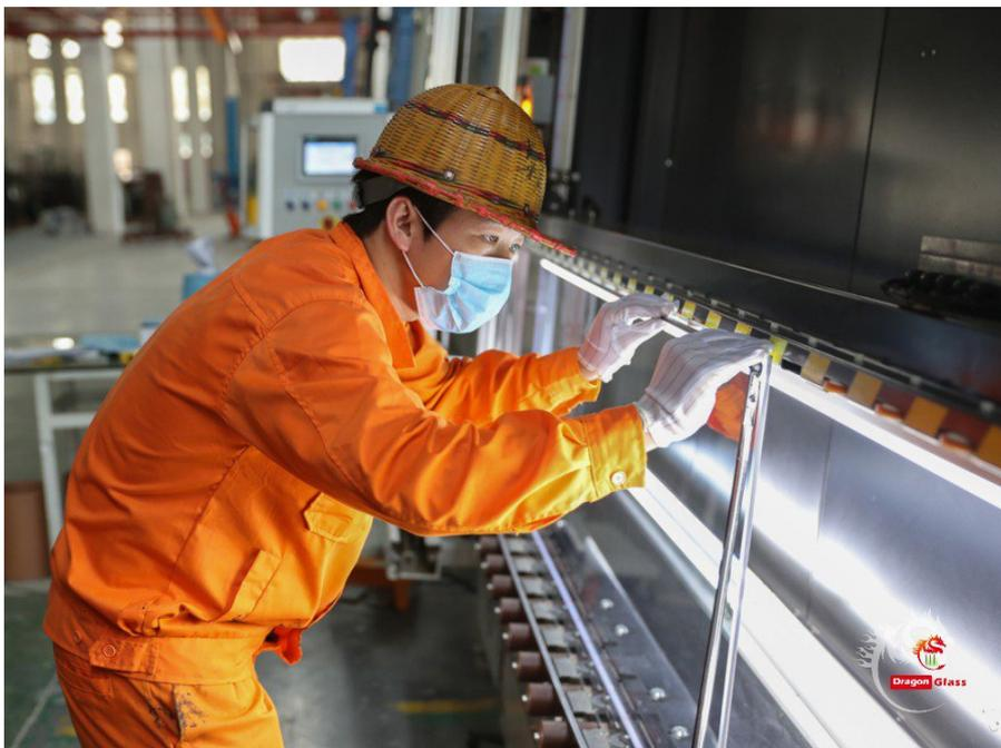
Duas peças de vidro temperado são separadas por um espaçador de alumínio 16A-27A e seladas juntas na borda, e persianas de alumínio construídas no interior, o espaço aéreo isolante é preenchido com ar seco ou argônio dentro para retardar a troca de calor e reduzir os níveis de ruído. O espaçador de alumínio é preenchido com pellets dessecantes de sílica para garantir a remoção de qualquer umidade no espaço aéreo.
