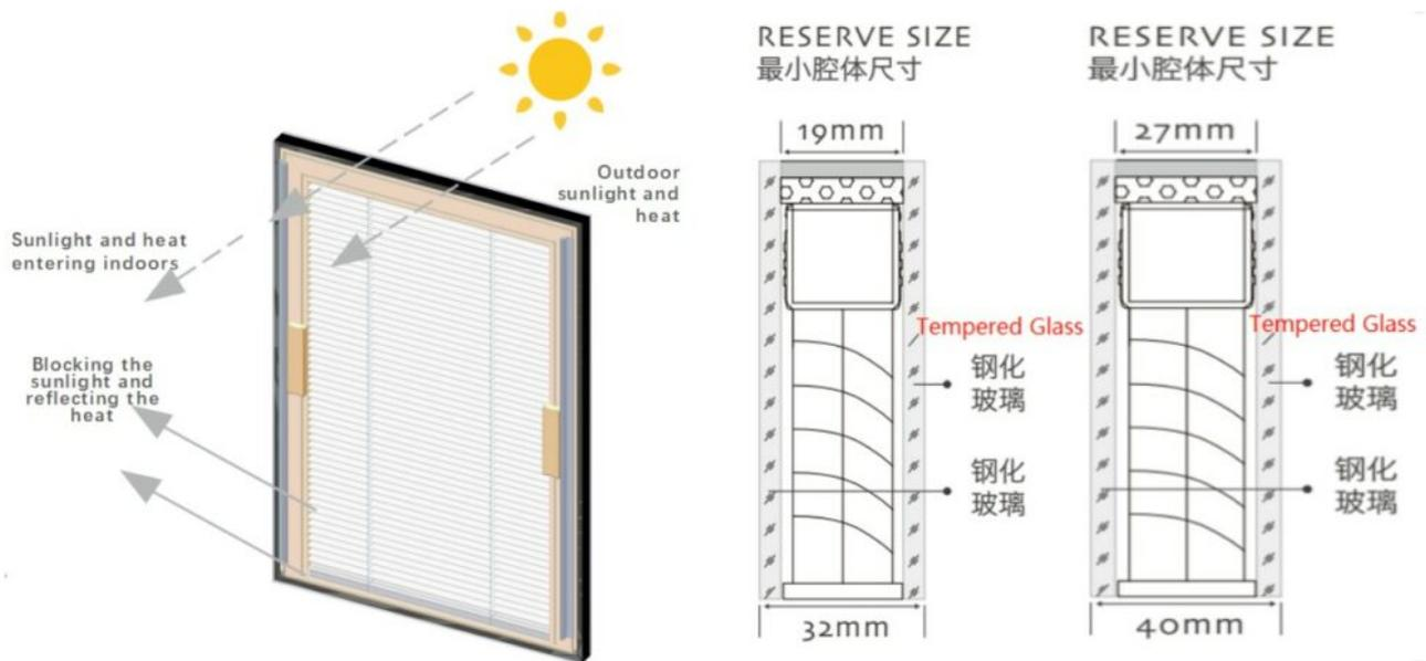
Fotos da estrutura do vidro isolado da grelha embutida
