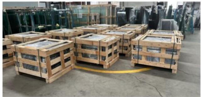
Todos usam caixas de madeira compensada de alta qualidade, e dentro das laterais de vidro estarão cheias de painéis de espuma anti-impacto
