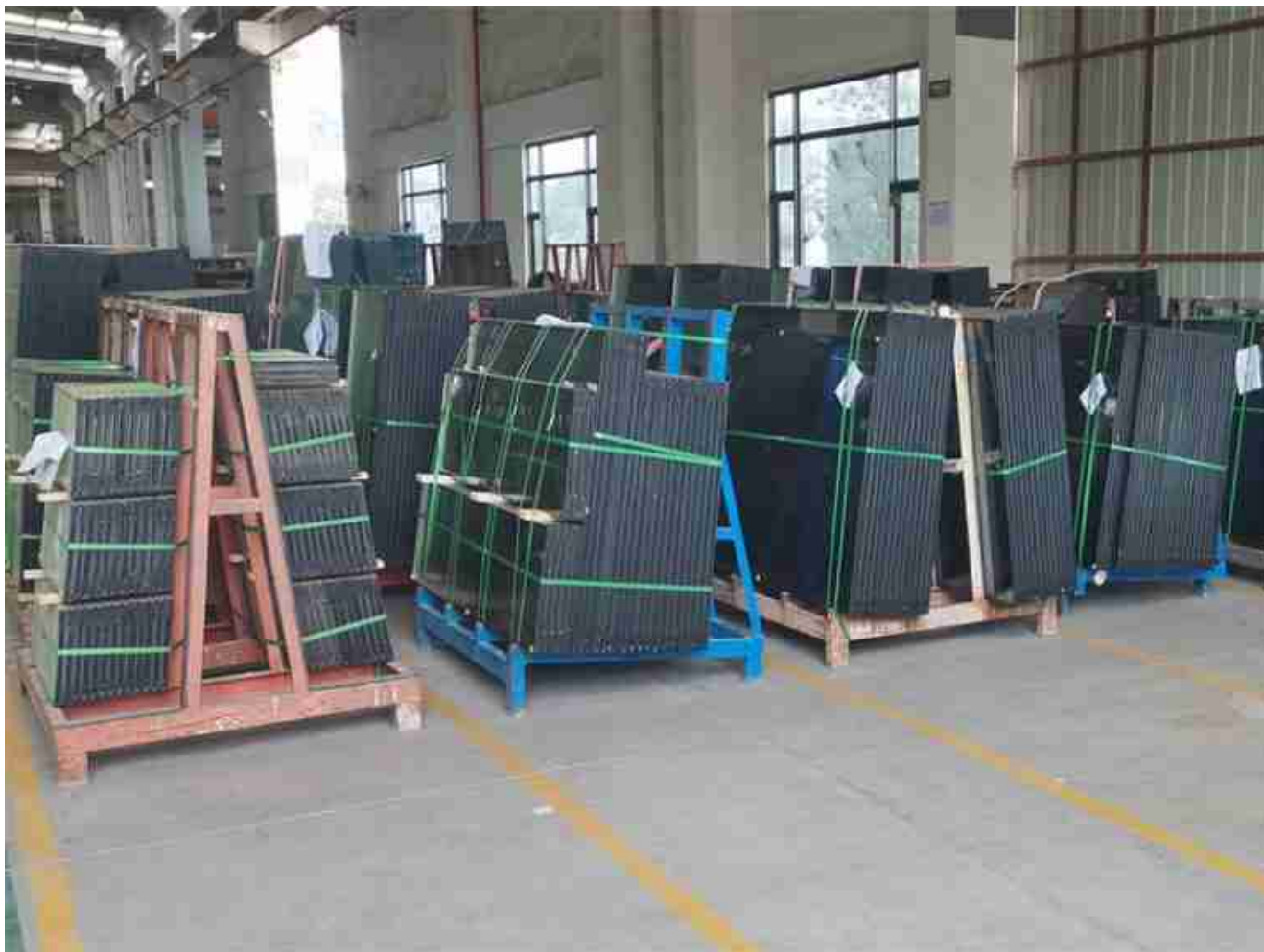
Painéis de vidro isolados
