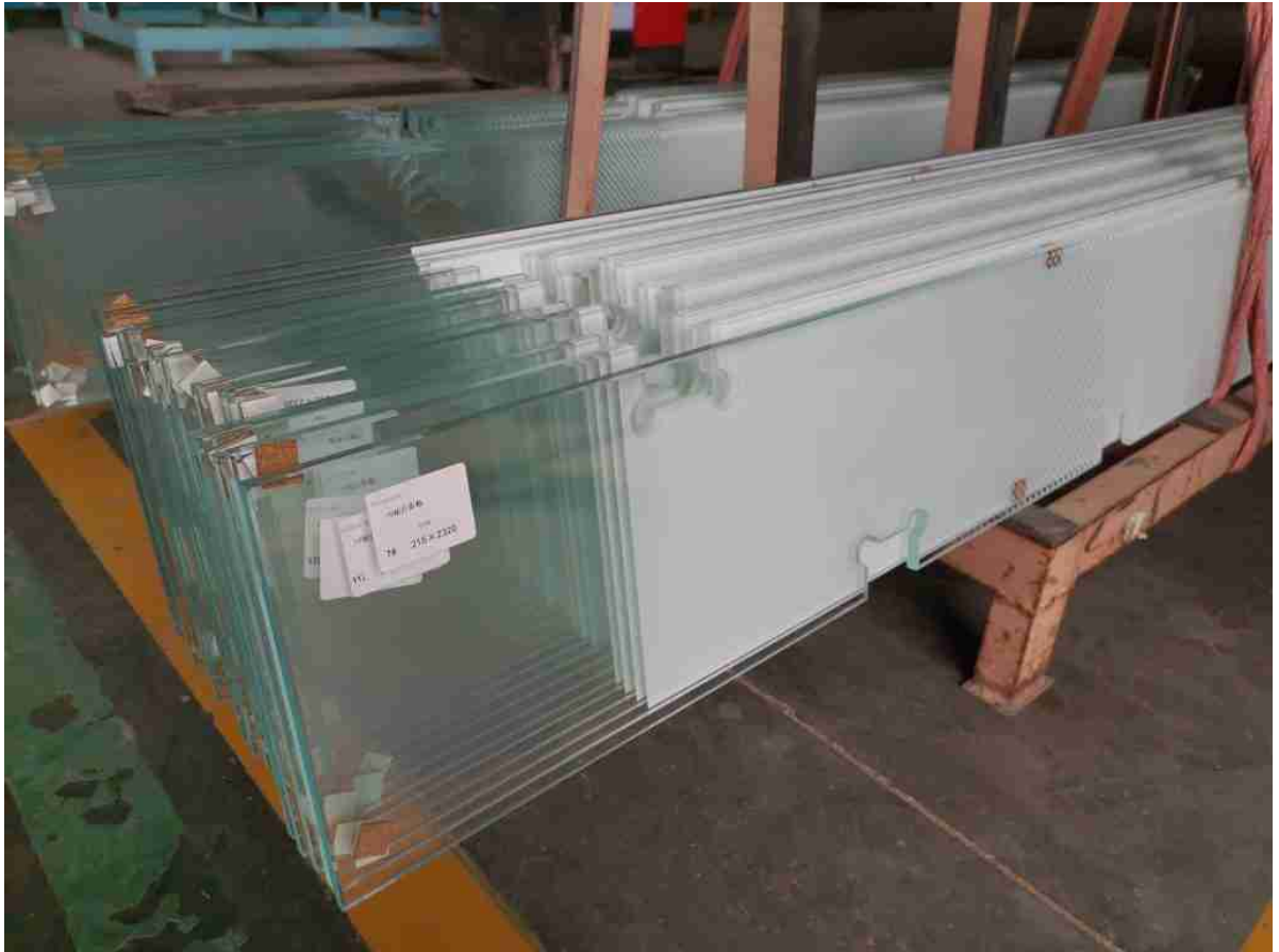
8 mm silketrykk i lavt jern, trykt tilpasset dusjskjermer
