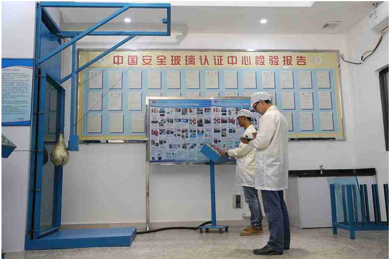
Slagtest for laminert glass.
