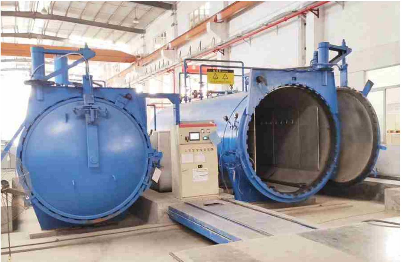
Laminert glass produksjonsmaskiner-høytrykks autoklav
