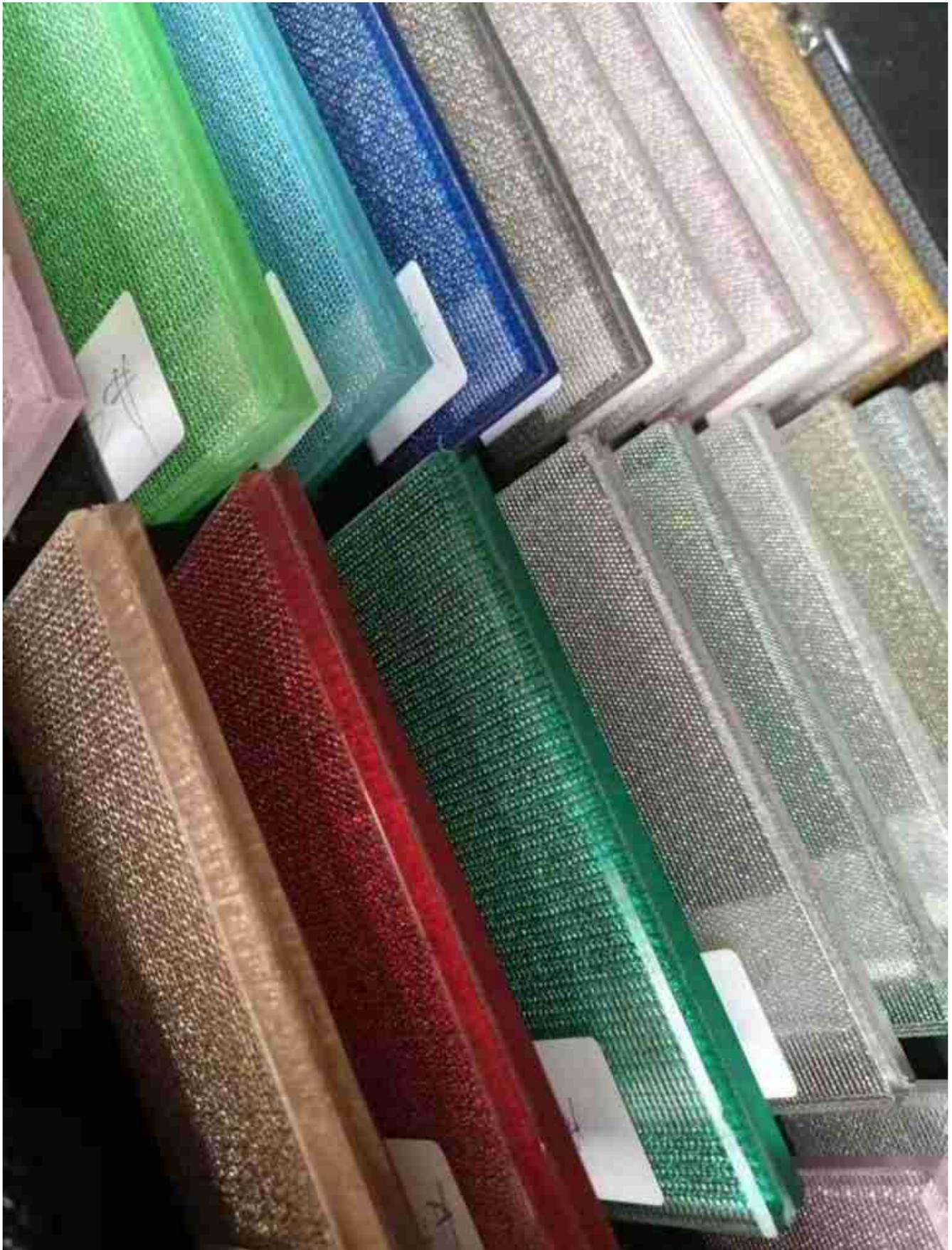
Fibre verre laminé est fait de deux ou trois couches de verre avec PVB ou SGP ou EVA dans le verre entre, à traiter avec haute température et haute pression.
