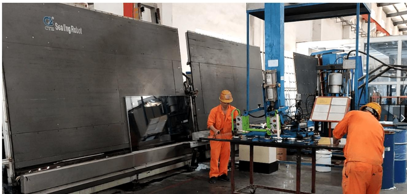
**Double vitrage avec étanchéité manuelle. Le verre isolé se compose de deux morceaux de verre ou plus.**
