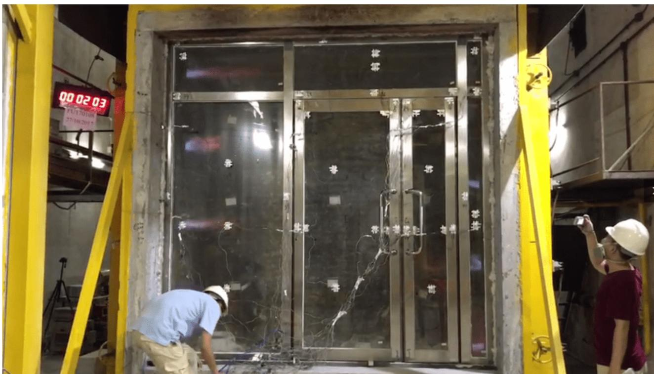
Test de porte en verre ignifuge en verre à double feu en verre ignifuge rated fire-rated
