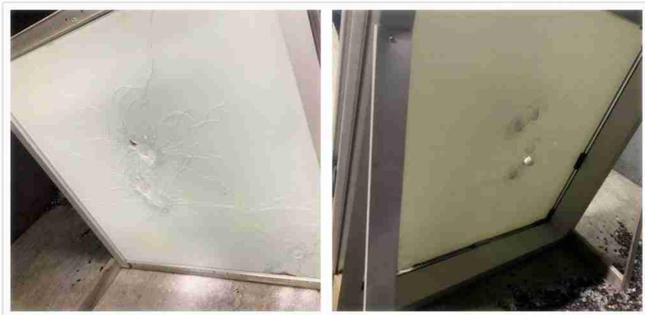
Le résultat du test de notre échantillon de verre pare-balles blanc laiteux de 20 mm.
