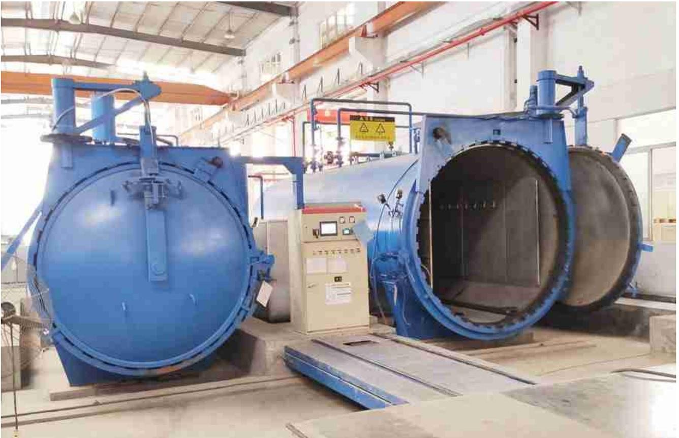
*Machines de fabrication de verre stratifié-autoclave à haute pression*
