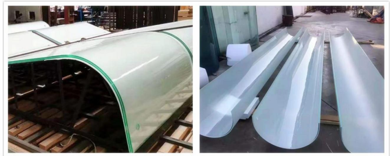
**Le verre bombé à froid** est également appelé verre trempé bombé ou verre trempé bombé. Il est traité dans un four de trempe. Une fois la forme souhaitée obtenue dans le moule incurvé de la ligne de trempe. Il sera refroidi rapidement à la température ambiante avec le puissant jet de vent. Le verre bombé à froid (verre trempé incurvé) a une résistance 5 fois supérieure à celle du verre recuit normal.
