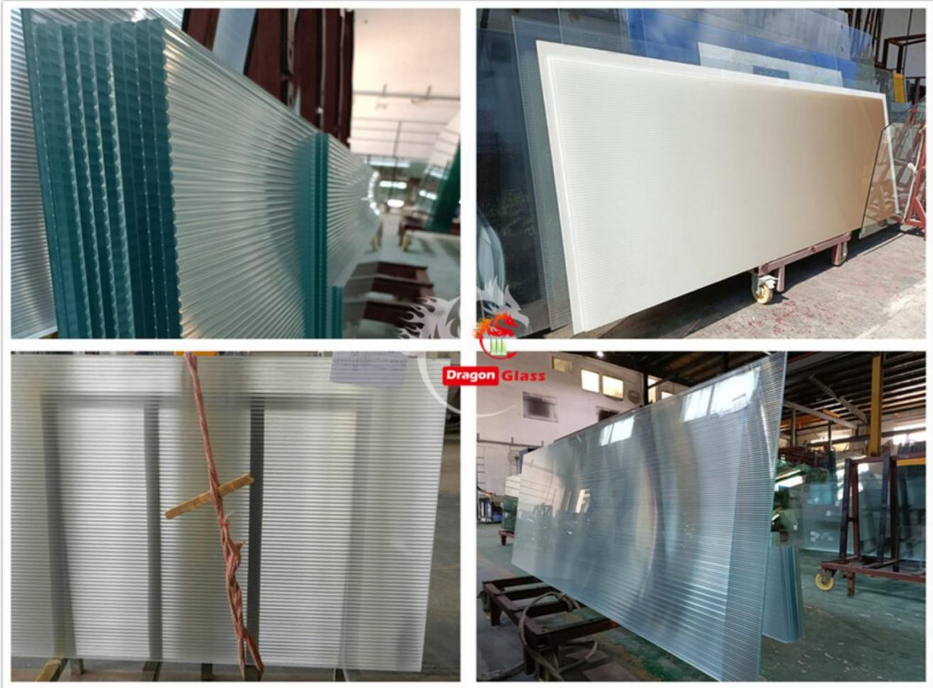
*Verre trempé cannelé en fer bas de 1/2 pouce, panneau de verre de sécurité à anches étroites cannelées de 12 mm pour la décoration intérieure*
