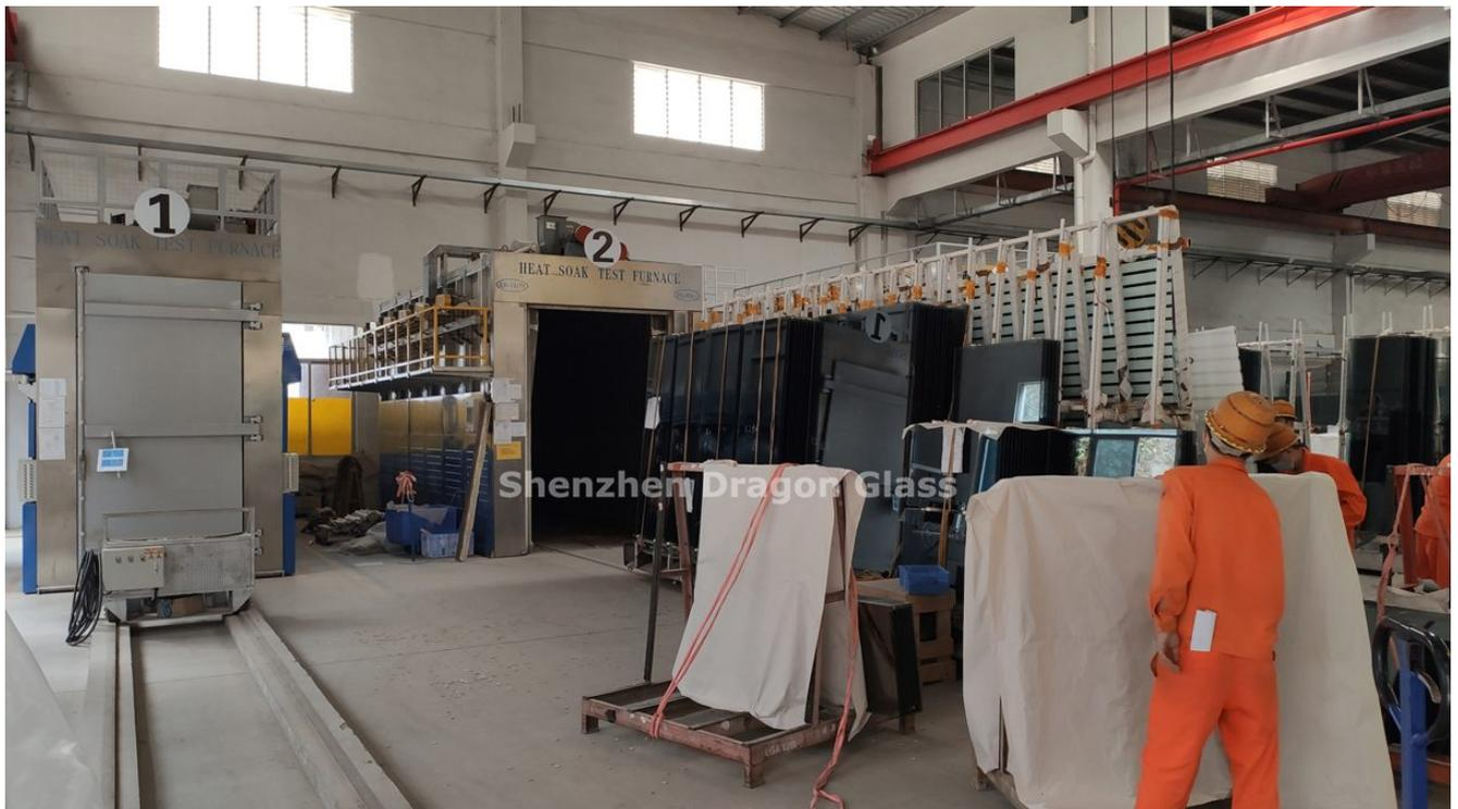
*four d'essai par immersion thermique*
