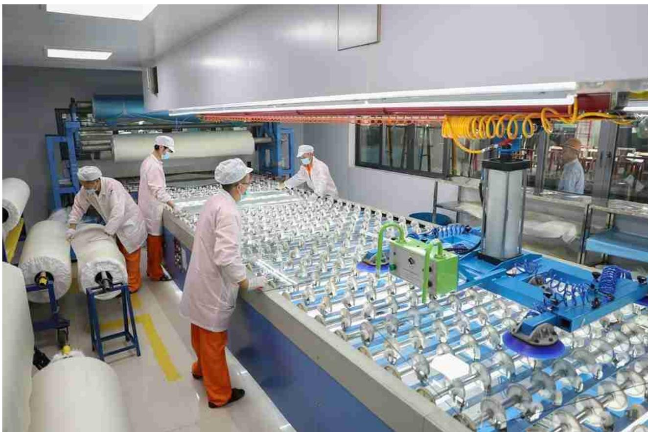
La production de verre feuilleté humide et de verre feuilleté EVA doit être couplée/combinée dans un environnement propre pour éviter la contamination du film colle/EVA pendant le processus d'aoiement/combinaison.
