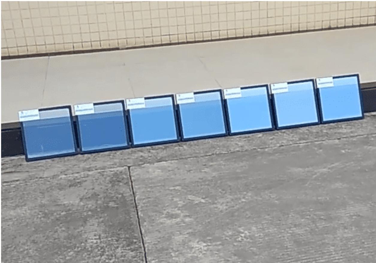
Bajo-E, o baja emisividad, se creó vidrio para minimizar la cantidad de luz infrarroja y ultravioleta que viene a través de su vidrio, sin minimizar la cantidad de luz que entra en su hogar. Las ventanas de vidrio Low-E tienen un recubrimiento microscópicamente delgado que es transparente y refleja el calor. ¡El recubrimiento es aún más delgado que el cabello humano! Los recubrimientos Low-E mantienen la temperatura en su hogar consistente al reflejar las temperaturas interiores en el interior.
