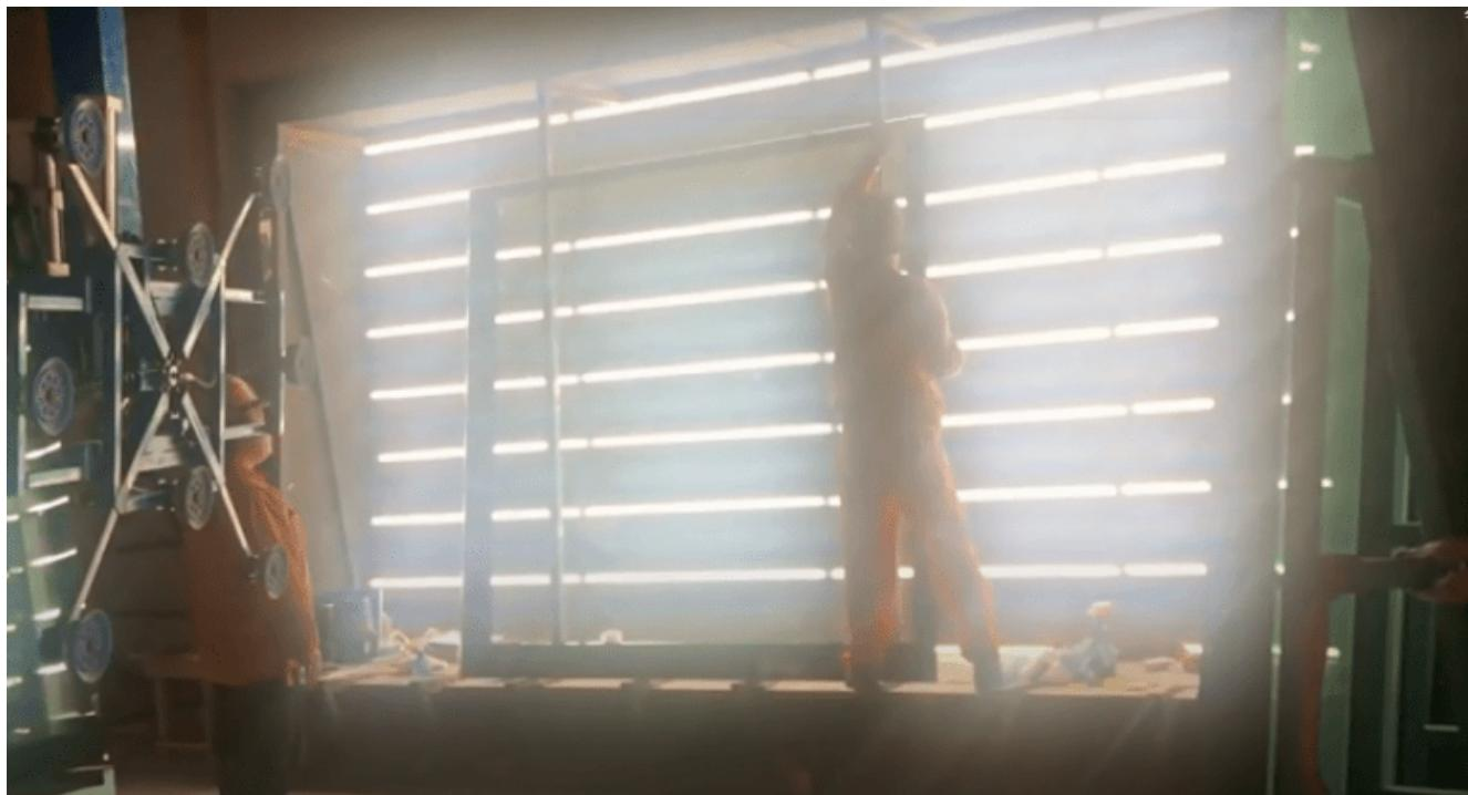
Control de calidad de la apariencia del vidrio Shenzhen Dragon Glass, incluyendo dimensión, apariencia, arco y deformación. A través de lightbox, compruebe por observación prospectiva, y comprobación visual, y regla de acero.
