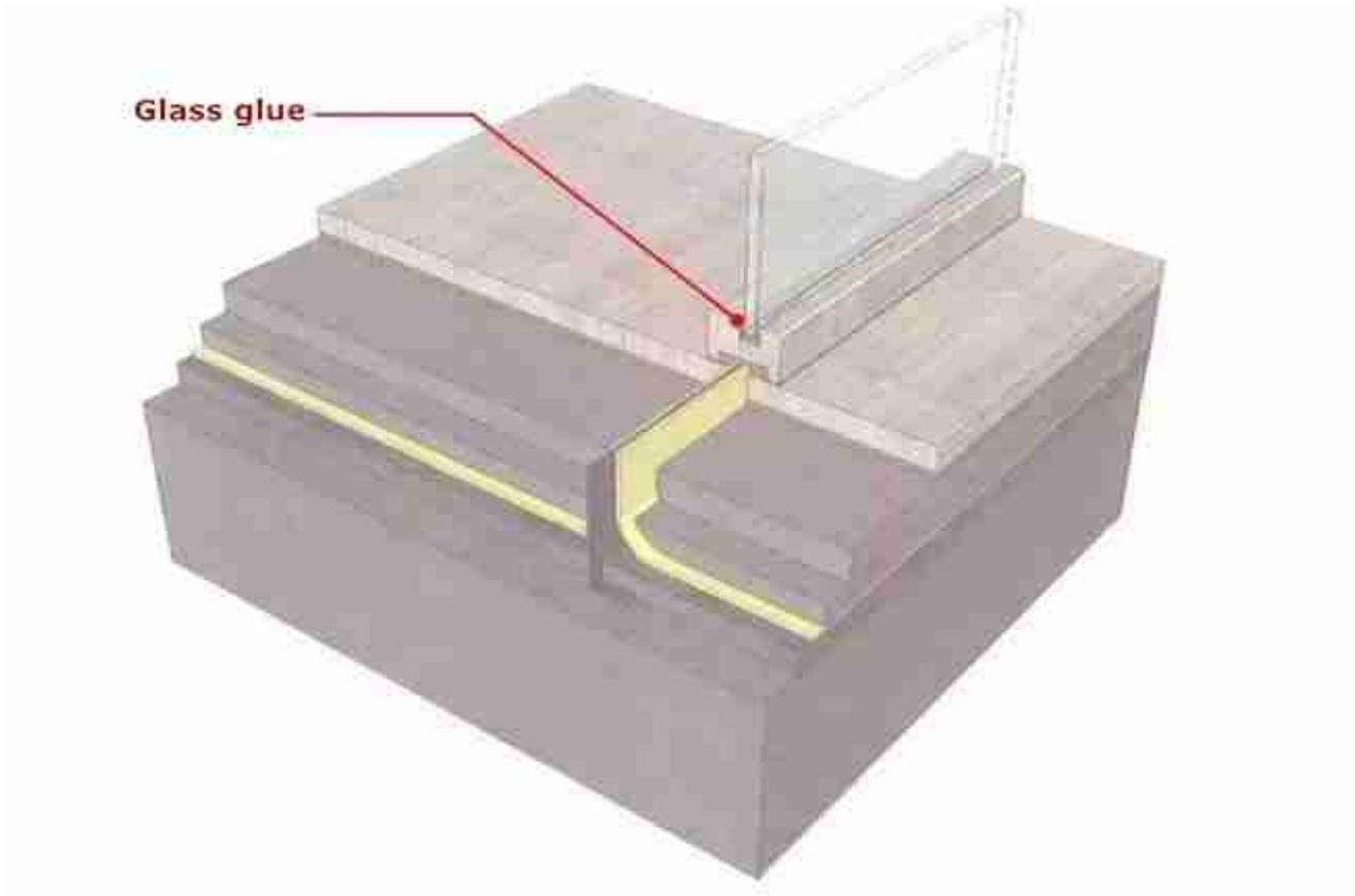
5. Instalar la partición de vidrio, antes de instalar, limpiar la ranura de vidrio para garantizar la limpieza de la superficie, para que pueda instalarlo en el interior! Después, ajuste la partición de pared de vidrio para asegurarse de que está fija.
