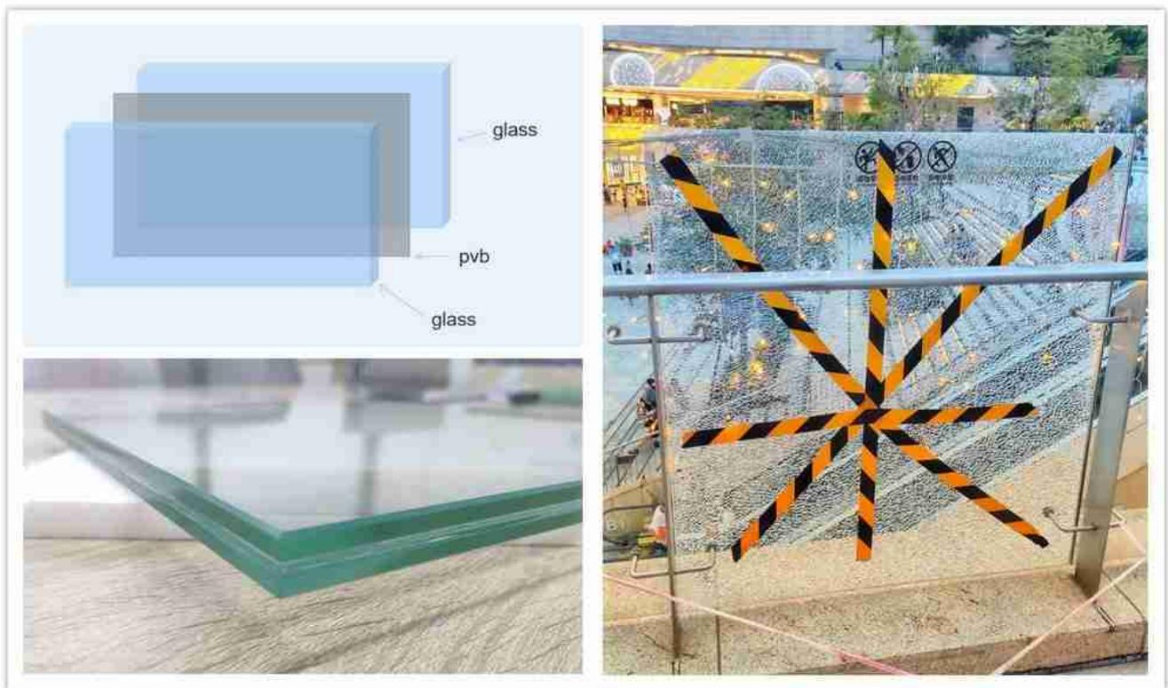
Vidrio laminado templado, cuando una pieza se rompe, el otro panel y el PVB pegarán el vidrio juntos tiempo de licitación para el reemplazo.
