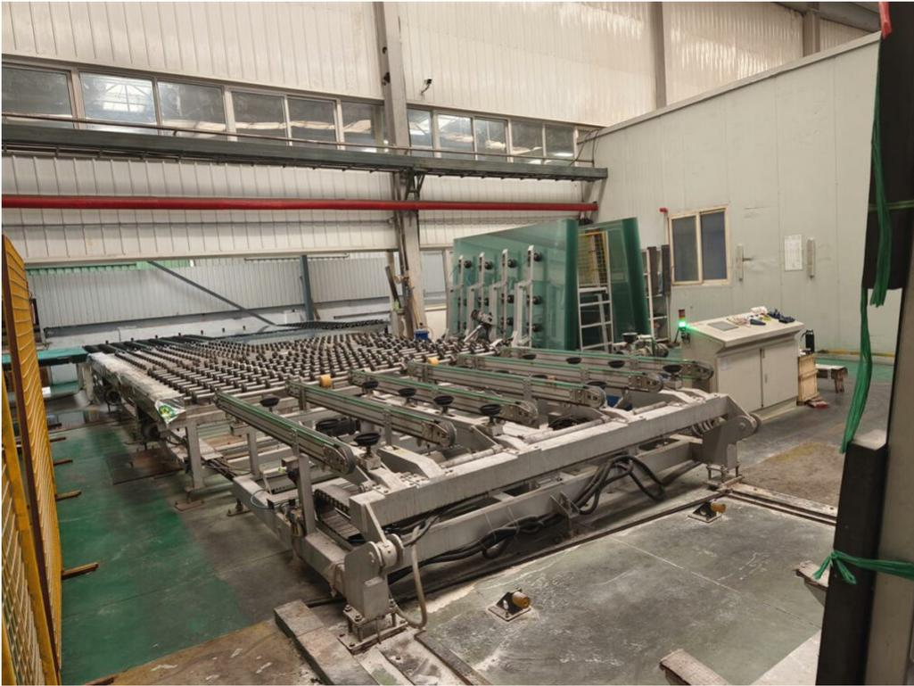
Lacado en la parte posterior del espejo, estar seco, luego lacado para que el usuario pueda tocar, estar seco, luego limpiar el lado del espejo, terminado
