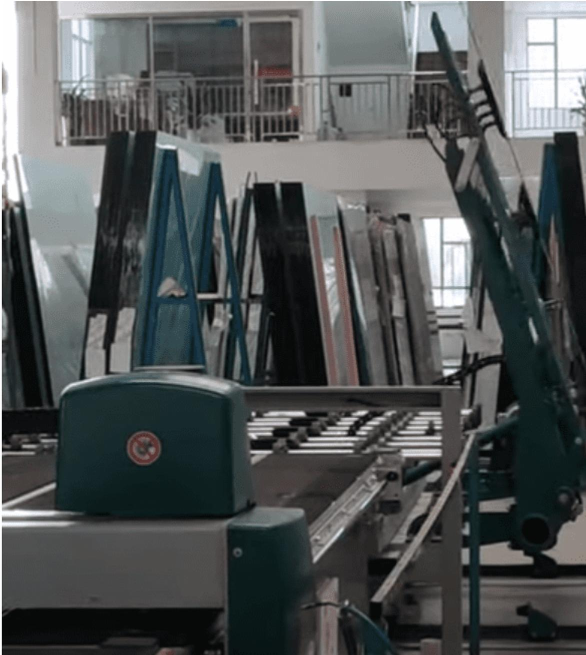
Máquina de corte automático, esta máquina asegura el corte de vidrio liso, con dimensiones precisas y buena calidad.
