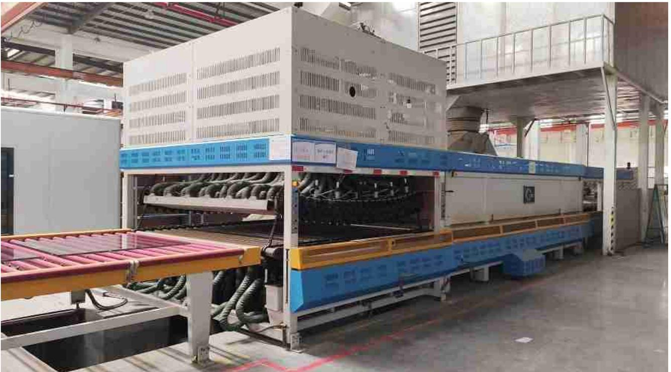
*Máquina de fabricación de vidrio templado curvado*
